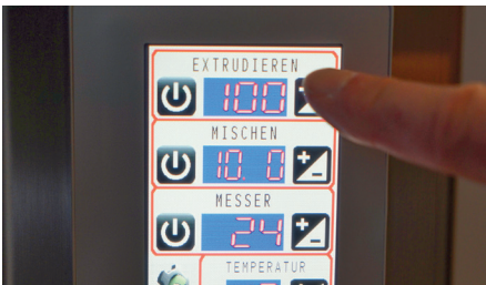
1. Mit - Symbol Geschwindigkeit für das Pressen (Extrudieren) auswählen. Mit das Pressen starten.
