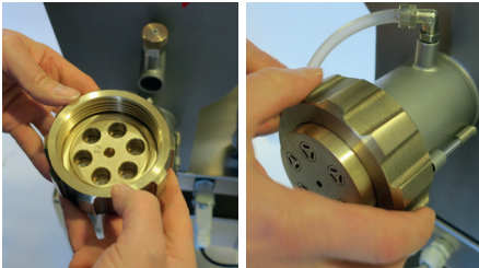
3. Matrize in die Überwurfmutter setzen und auf den Presshals aufschrauben. Mit dem Matrizenschlüssel leicht festziehen.
